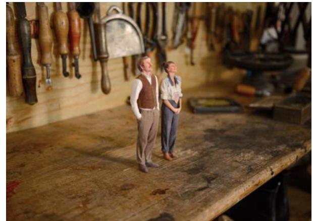
Die 3D-Figuren werden mit Hilfe eines sogenannten Multicolor-Printer hergestellt. Dabei kommt nicht wie bei klassischen 3D-Druckern, die inzwischen teilweise auch schon im Heimgebrauch eingesetzt werden, eine Plastikspule zum Einsatz, 4. Stattdessen wird ein feinkörniges Pulver verwendet, das in Zehntelmillimeterschichten aufgetragen wird. 5 schießen ein Bindemittel in das Pulver, das eingefärbt wird.
